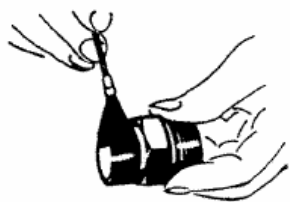
Рис. 4 Резьбу хорошо смазать маслом
