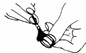
Рис. 6 Врезное кольцо со всех сторон хорошо смазать маслом
