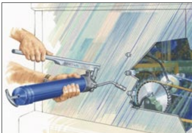
Ручная смазка Каждая смазочная точка смазывается отдельно
