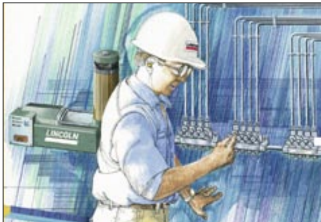
Автоматическая система централизованной смазки Все смазочные точки обеспечиваются смазочным материалом во время работы машины
